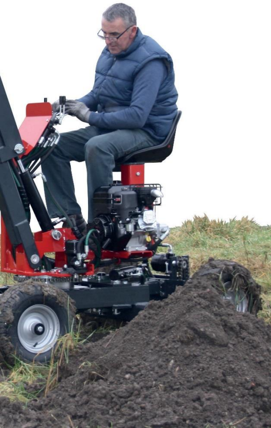
Mininakladač s vlastním motorem a kolovým podvozkem
