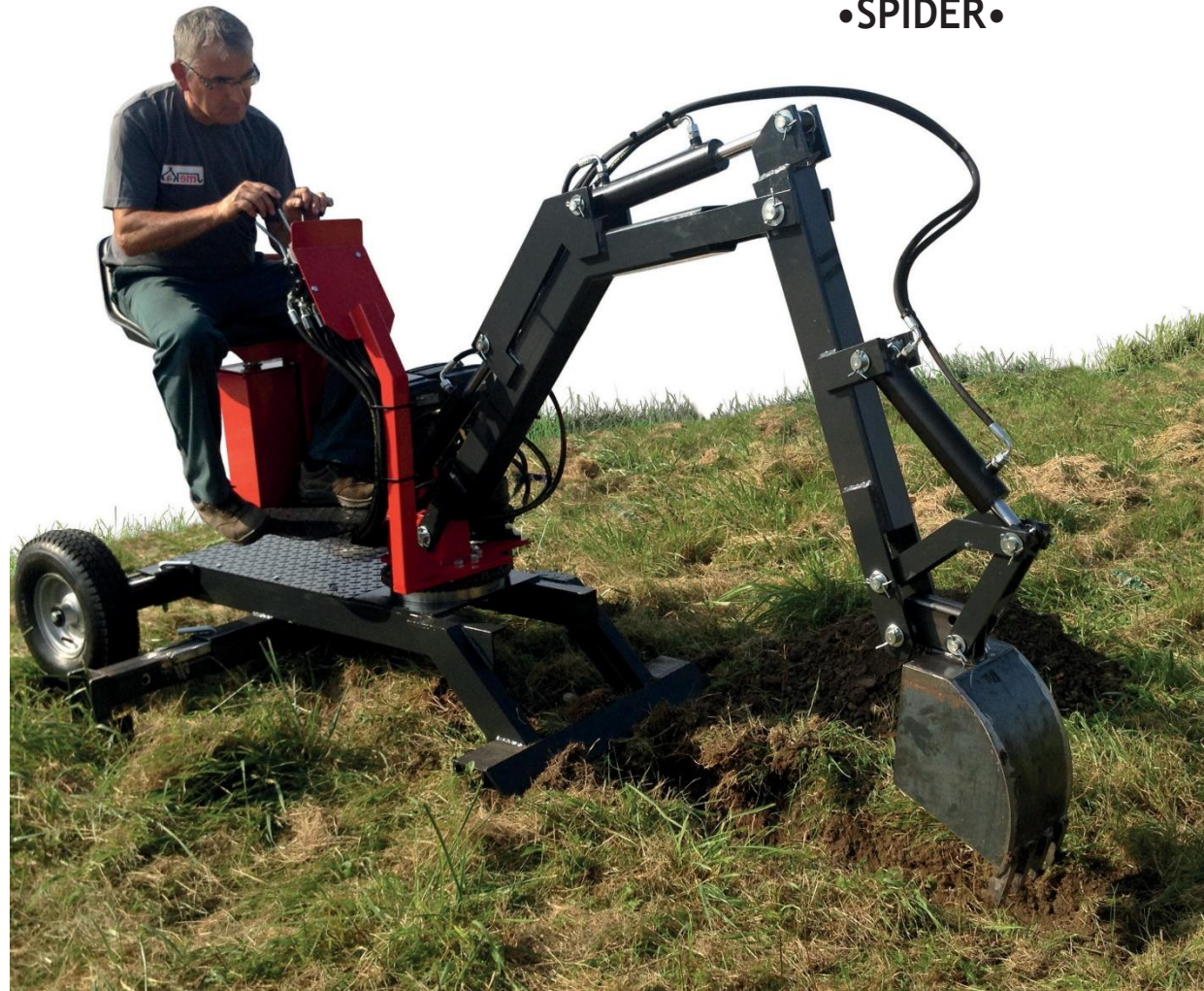
Verze Spider se dvěma koly a stabilizačním nosníkem
